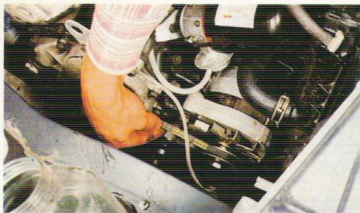
**1** Vérifiez que la courroie d'alternateur n'est pas fendillée ou craquelée. Remplacez-la si nécessaire et réglez la tension en déplaçant l'alternateur.
