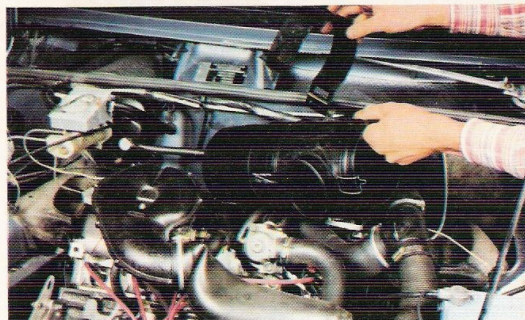
6 Le boîtier de filtre à air est retenu par un clip et une bride qu'il faut démonter pour le dégager; bien entendu, il faut enlever la Durit de prise d'air.
