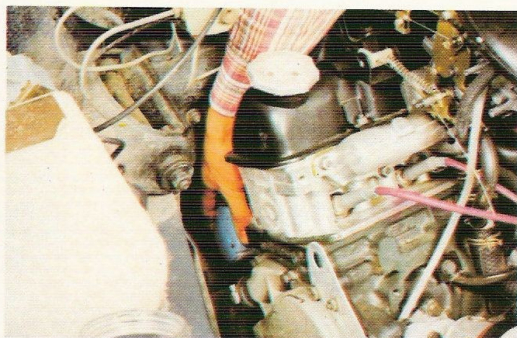
10 Le filtre à huile est situé à l'arrière du moteur. Pour le retirer, il est nécessaire d'employer une clé spéciale. Vissez le neuf à la main sans forcer, après avoir légèrement enduit son joint d'huile.
