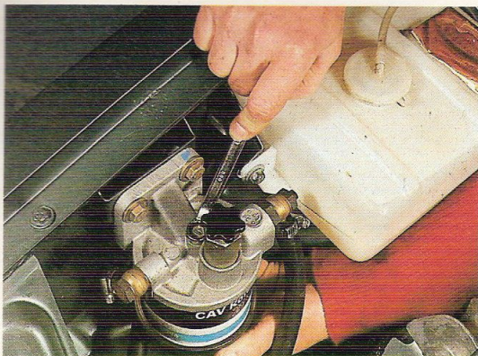
4 Pour remplacer la cartouche du filtre à gazole, dévissez la vis supérieure tout en maintenant la cuve en verre. Remplacez la cartouche.
